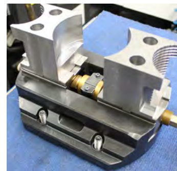
Spannvorrichtung, die mechanisch, hydraulisch oder pneumatisch eingesetzt werden kann.
