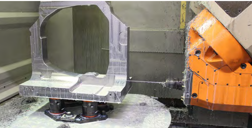
Prozessoptimiertes CNC-Fräsen und Tieflochbohren mit ein und demselben Kühlschmierstoff.
