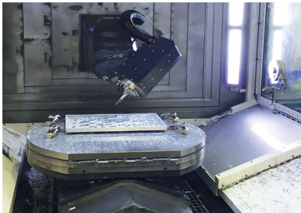
Maho DMU 160 5-Achs-CNC Fräsmaschine. Die Schmierstoffumstellung brachte deutliche Verbesserungen mit sich.
