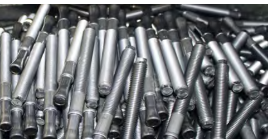
Befestigungselemente hergestellt durch Massivkaltumformung.
