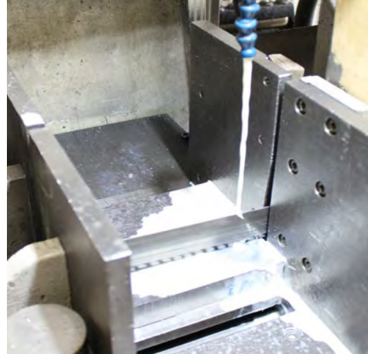
Beim Sägen und Fräsen der Test-Werkstücke kommt bei ELEMENT ein und derselbe Kühlschmierstoff von Oest zum Einsatz.
