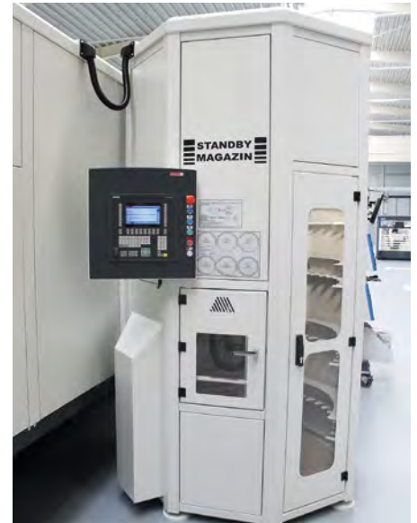
Standby-Magazin für bis zu 200 Werkzeuge.
