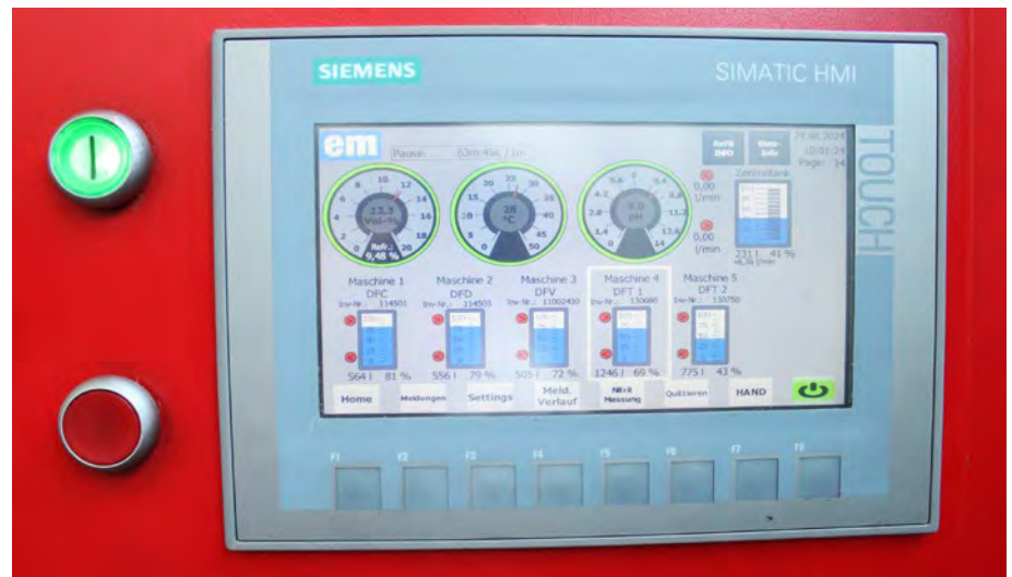
Mit der automatisierten Kühlschmierstoffüberwachung durch LiquidMate® sind stets alle relevanten Daten abrufbar.
