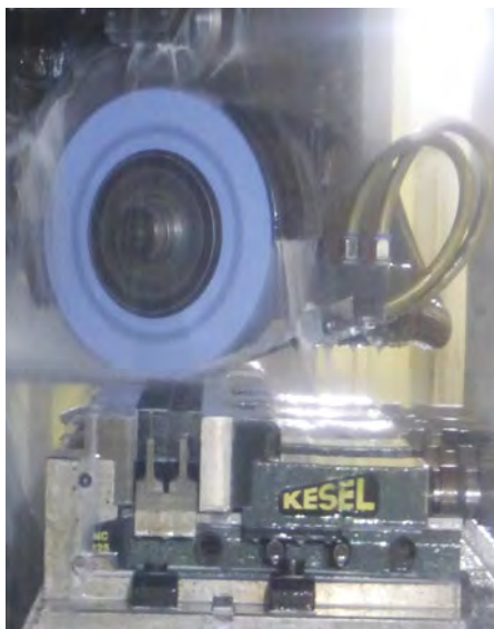
Kühlschmierstoff kann zur Prozessoptimierung und Standzeitverlängerung beitragen.
