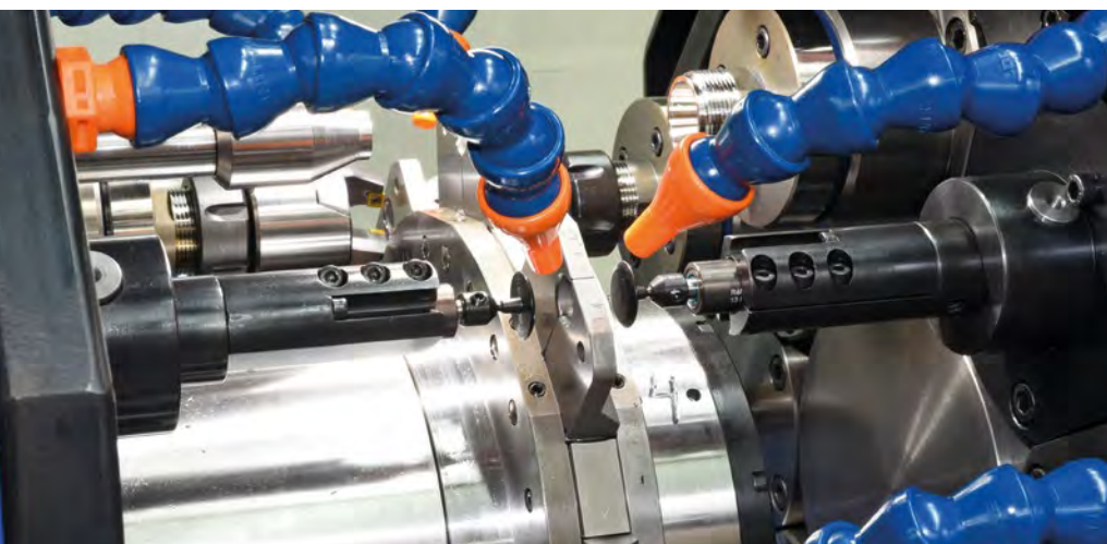
Der Schaltteller dreht sich getaktet um die eigene Achse von Station zu Station.
