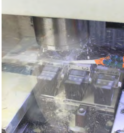
Beim Sägen und Fräsen der Test-Werkstücke kommt bei ELEMENT ein und derselbe Kühlschmierstoff von Oest zum Einsatz.
