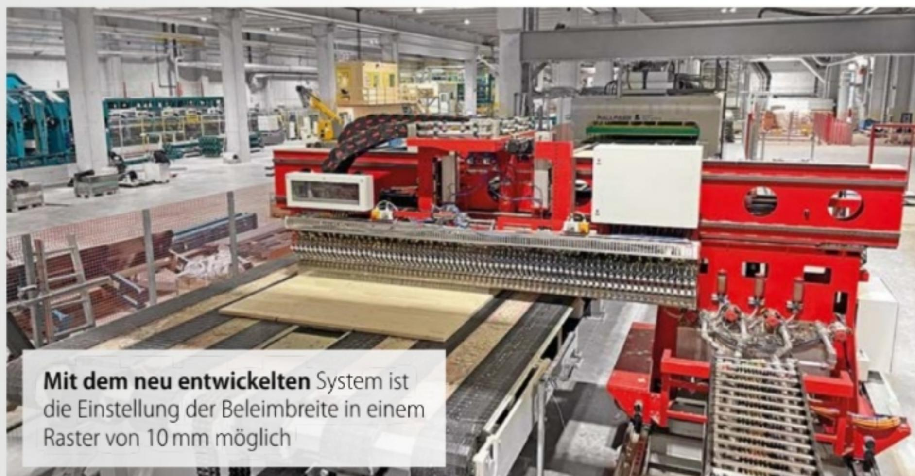
Mit dem neu entwickelten System ist die Einstellung der Beleimbreite in einem Raster von 10 mm möglich
