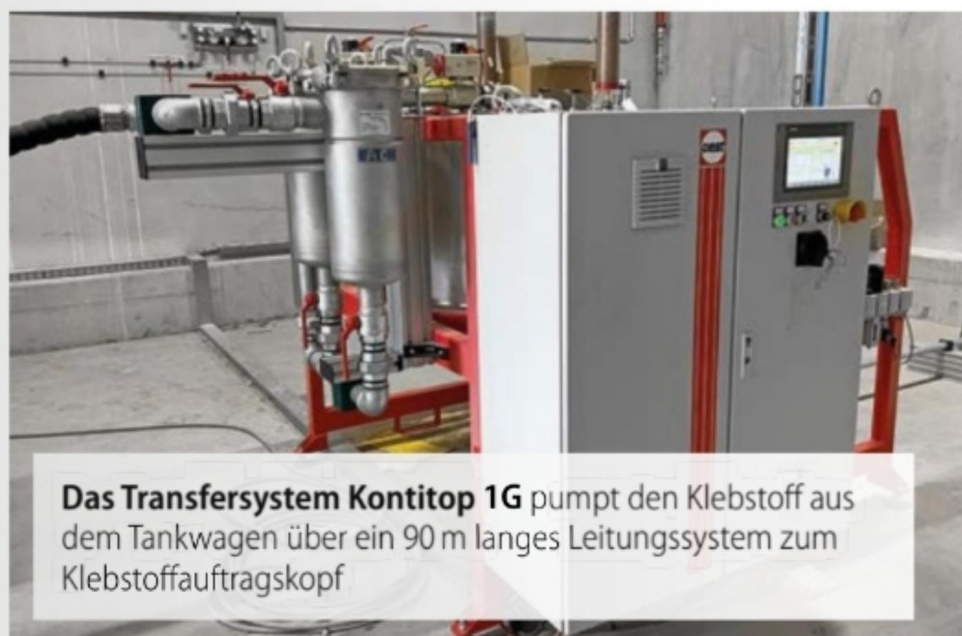
**Das Transfersystem Kontitop 1G** pumpt den Klebstoff aus dem Tankwagen über ein 90 m langes Leitungssystem zum Klebstoffauftragskopf
