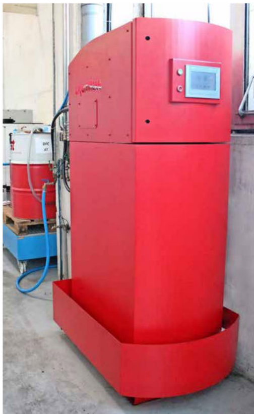
Herzstück von Liquidmate ist ein zentraler Versorgungstank, der 560 l fasst und die sichere Versorgung der Maschinen gewährleistet.
