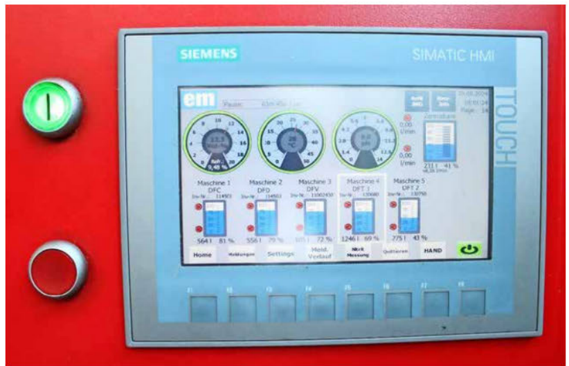
Mit der automatisierten Kühlschmierstoffüberwachung durch Liquidmate sind stets alle relevanten Daten abrufbar.
